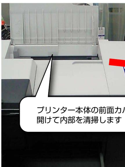
プリンター本体の前面カバーを開けて内部を清掃します
