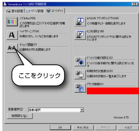
画面の指示に従って操作し、ノズルの調整を行ってください
