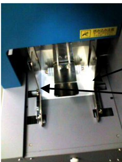
左右の用紙押さえガイドを用紙にピッタリと付くように挟んでください。用紙と用紙押さえガイドに隙間が出来てしまうと印字斜行の原因になります。
